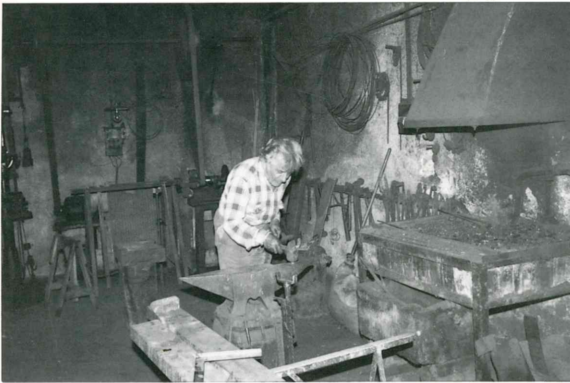
Façonnage d'une pièce métallique sur l'enclume de la forge de M. G. Macari. Photo Jean-Pierre GARACIO
