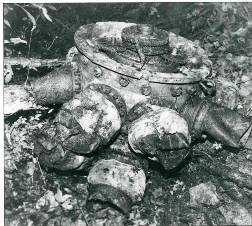
Vue des restes du moteur de l'avion P47, avec ses deux rangées de cylindres décalés. Photo Philippe CASTELLANO
