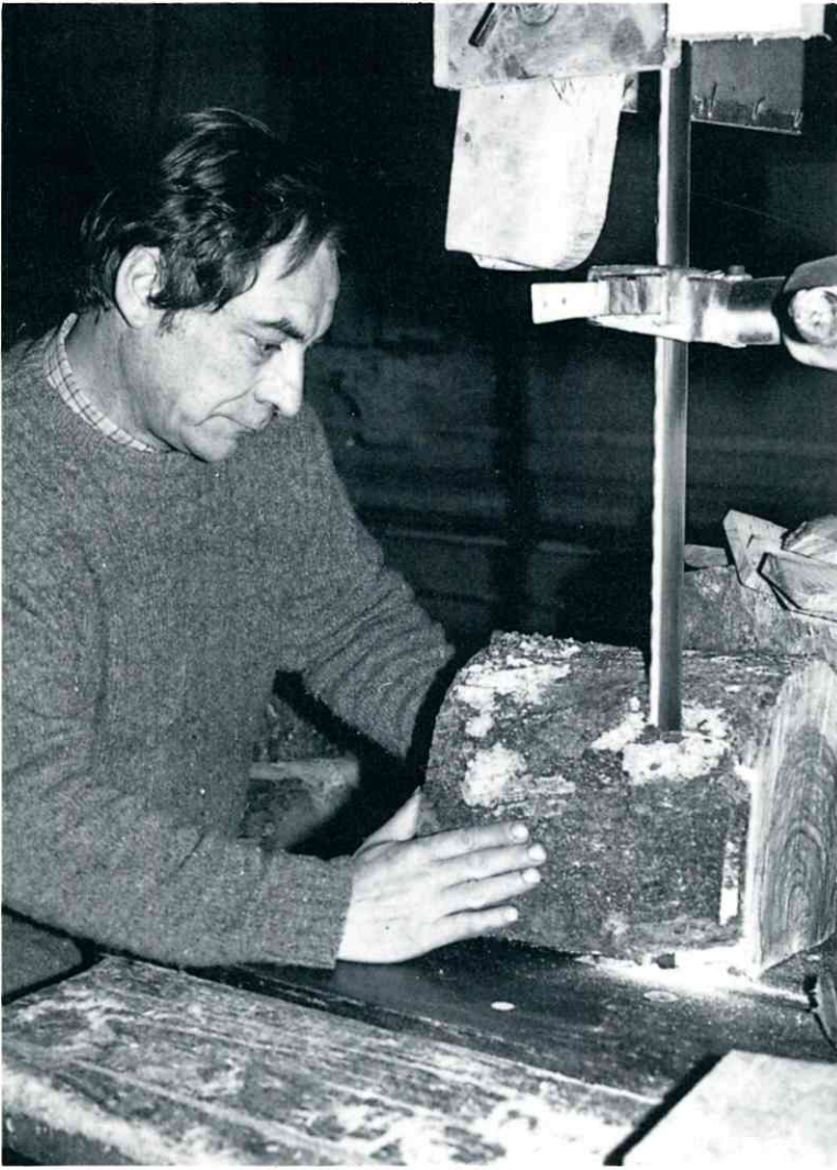
Quelques étapes du travail du bois... Ci-dessus, dégrossissage d'un bloc à la scie à ruban, et évidage d'un futur récipient à l'herminette. Ci-dessous, finition d'objets à la meule et à la main. Photos Elisabeth PÉRUS
