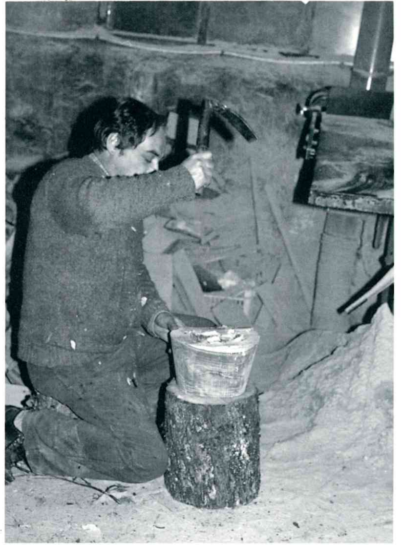
Quelques étapes du travail du bois... Ci-dessus, dégrossissage d'un bloc à la scie à ruban, et évidage d'un futur récipient à l'herminette. Ci-dessous, finition d'objets à la meule et à la main. Photos Elisabeth PÉRUS
