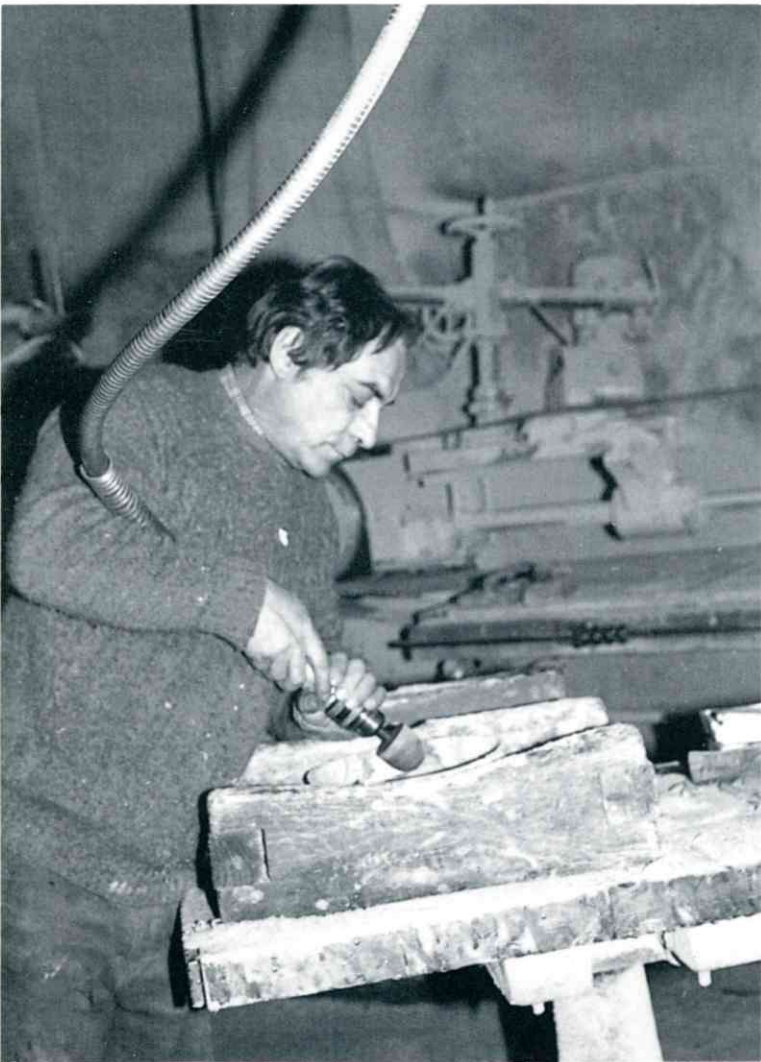
Quelques étapes du travail du bois... Ci-dessus, dégrossissage d'un bloc à la scie à ruban, et évidage d'un futur récipient à l'herminette. Ci-dessous, finition d'objets à la meule et à la main. Photos Elisabeth PÉRUS
