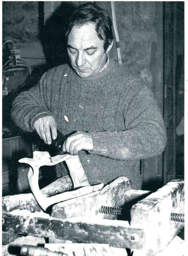
Quelques étapes du travail du bois... Ci-dessus, dégrossissage d'un bloc à la scie à ruban, et évidage d'un futur récipient à l'herminette. Ci-dessous, finition d'objets à la meule et à la main. Photos Elisabeth PÉRUS
